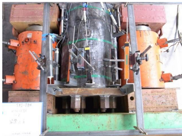
引張り試験(荷装置全景)
