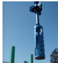
3. 拡底掘削 (EAGLE バケット)
