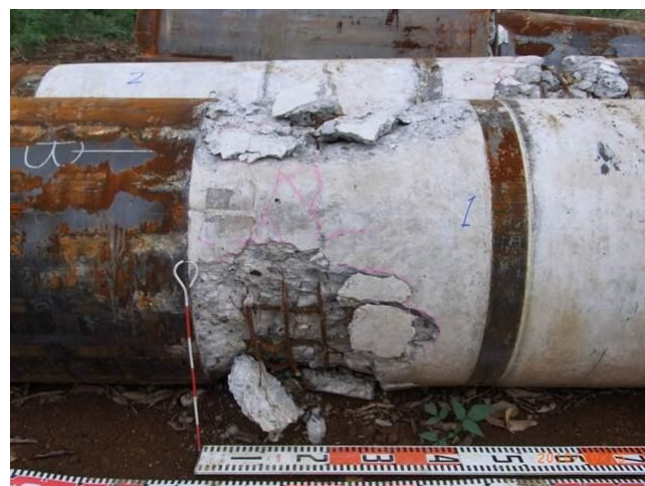
曲げ試験(試験後状況)
