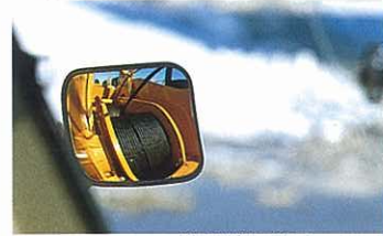
▲ドラムミラーでドラムの巻取状態もひと目で。
